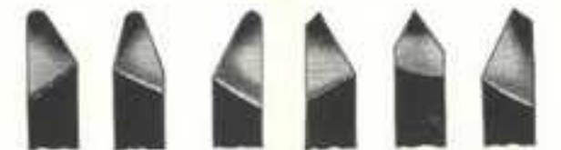
A L. H. Round R. H. L. H. Thread- E. Thread- F. R. H. Side Turning Nose Turning Side ing ing Side Fig. 44. Set of Ground Cutter Bits
