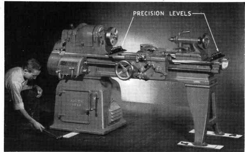
Fig. 23. Leveling the Lathe
